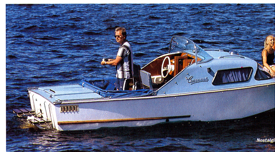
Nedan: Den lilla kabinbåten tillverkades av Båtindustri AB i Köping under 60-talet. Den har svag V-botten akteröver och dubbla bottenar med flytelement. BIA byggde plastbåtar från 1959 till början av 80-talet
